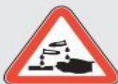
OPASNOST OD KOROZIJE
