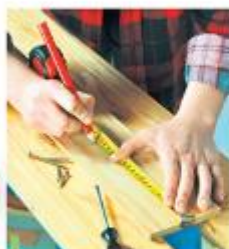
4.59. Мерење и обележавање металним метром
